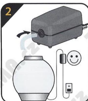
Připojte vzduchovací hadici z akvária do vzduchovacího čerpadla, umístěte jej nad budoucí hladinu akvária (viz. obr.) a zapněte ho. **V případě výpadku proudu by mohlo nastat riziko, že by voda vtekla do vzduchovacího čerpadla, pokud by bylo pod úrovní hladiny.**
